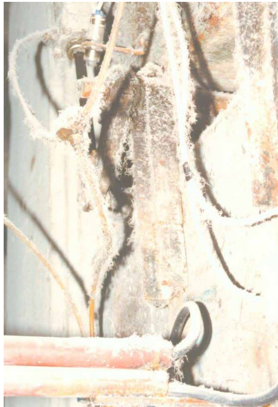
Azbestna vlakna na mešalniku v času intenzivne proizvodnje v Salonitu Anhovo
